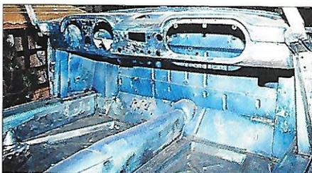
Le second problème révélé par les Touring et Zagato vient des phénomènes électrolytiques aux points de contact entre plate-forme en acier et peau en alu.
