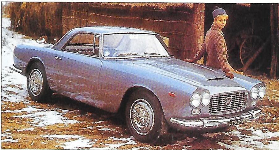
ries de Kamm sur les turbulences, la jupe arrière est à pan coupé, tandis que les phares sont à nouveau en retrait de la calandre, mais sans carénage. Des carburateurs plus gros l'amènent à 152 ch et 210 km/h, les meilleurs chiffres jamais obtenus par une Flaminia... si l'on excepte les "spéciales" préparées par Elio Zagato pour la compétition et pilotées *con molto brio* par lui-même, les frères Frescobaldi, Gabianca ou un cer-
