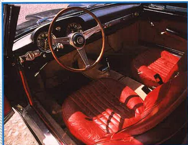
Un imposant vitrage confère clarté et atmosphère accueillante à l'habitacle. Le tableau de bord, avec ses grands instruments ronds, est parfaitement lisible. Le support d'instruments en tôle est peint dans la couleur de la voiture. Les autres matériaux sont le chrome, l'alu, le cuir et, comme il se doit, le bois pour le volant.
