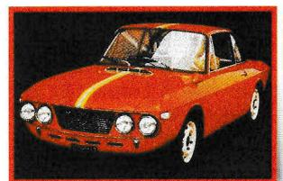
**1967 :** nouveau coupé Rallye (1 298 cm<sup>3</sup>, 87 ch, portes et capots aluminium), 168 km/h. Nouvelle 1.3 HF (101 ch), 174 km/h. Nouvelle berline GT (1,2 l, 80 ch).
