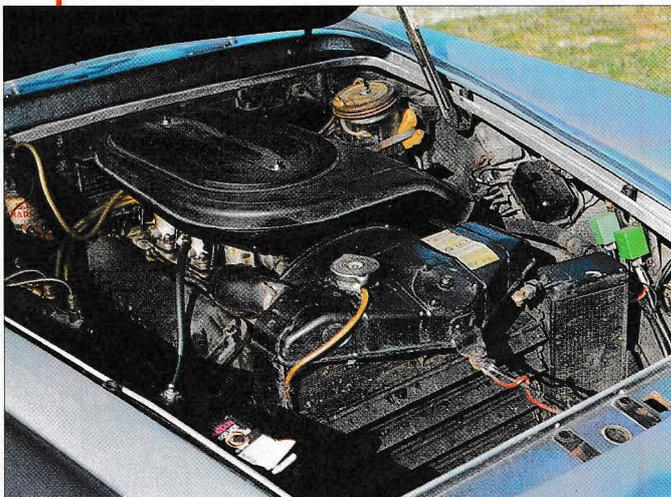
Un compartiment-moteur bien rempli, notamment par le radiateur d'huile et le généreux filtre à air. Sans cela, le V 6 à culbuteurs, qui développe 146 ch dans cette version 3 C de 2,8 l, est plutôt compact.
